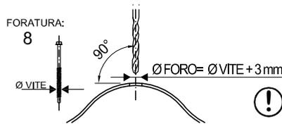
8. PER ESEGUIRE FORATURA IN CANTIERE UTILIZZARE: TRAPANO CON ADEGUATE PUNTE. REALIZZARE FORI NELLA LASTRA CON DIAMETRO MAGGIORATO DI 3 mm RISPETTO AL DIAMETRO DELLA VITE O ASOLARE IL FORO NEL SENSO LONGITUDINALE
